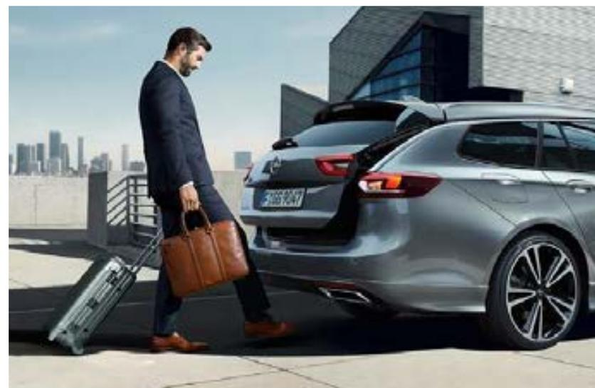
**Hayon motorisé mains-libres<sup>2</sup>.** Ouvrez le hayon en passant simplement votre pied sous le pare-chocs arrière, là où vous voyez la lumière LED blanche projetée sur le sol. Un second mouvement permettra la fermeture du hayon.
