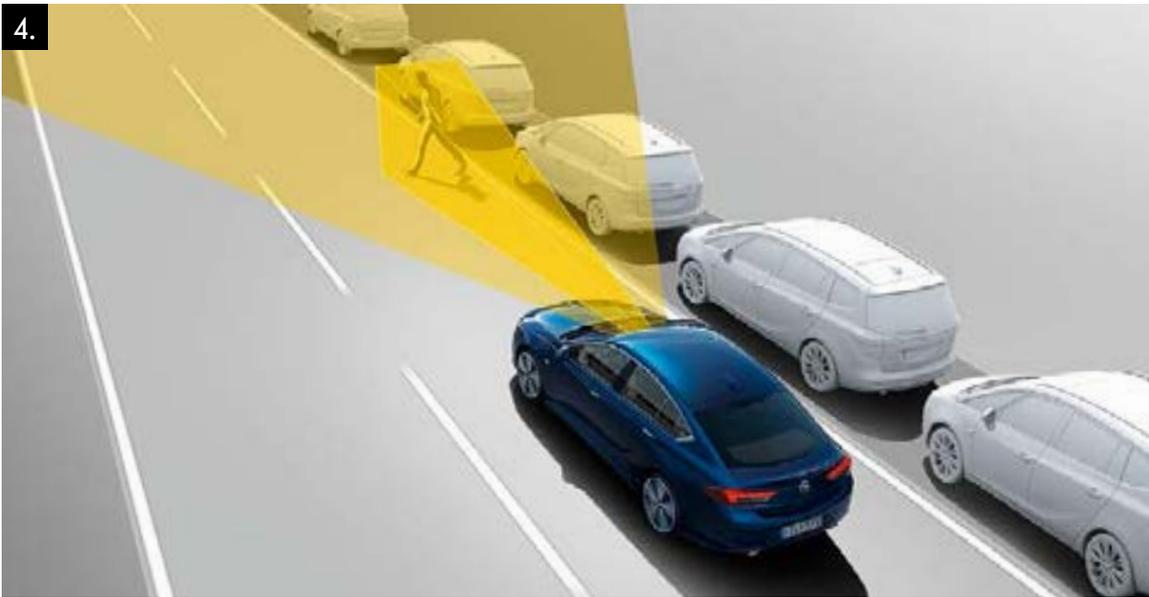
**4. Freinage d'urgence automatique avec détection des piétons<sup>3</sup>.** Si ce système détecte un piéton, un véhicule ou un autre objet à l'avant, il pré- augmente la puissance de freinage et va jusqu'à freiner si le conducteur ne réagit pas.
