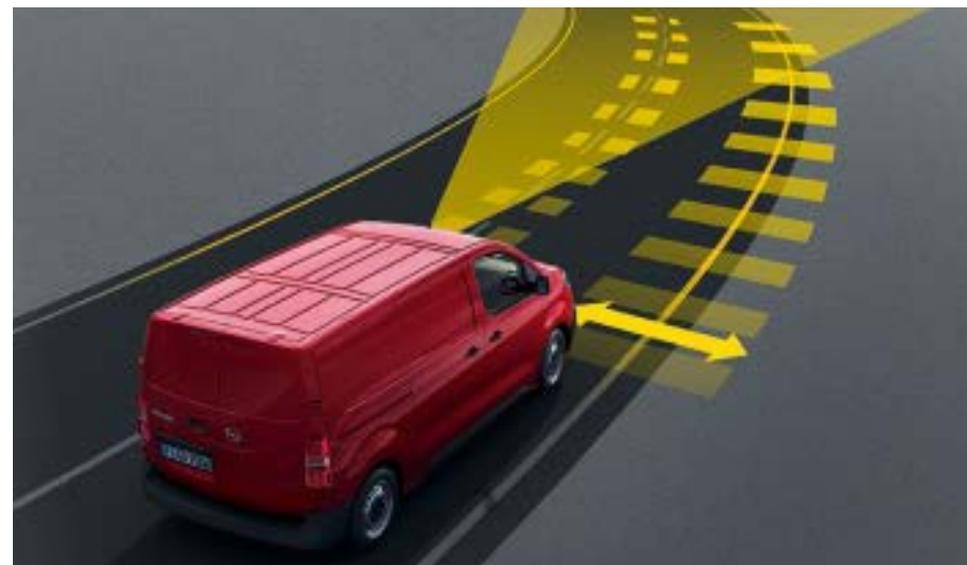
**Assistance au maintien dans la voie<sup>1</sup>**: Détecte la dérive involontaire du Vivaro et alerte le conducteur par des signaux sonores et visuels.
