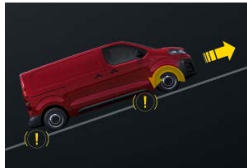
**Aide au démarrage en côte<sup>1</sup> :** empêche le véhicule à l'arrêt dans une pente de reculer et maintient le freinage le temps d'atteindre la pédale des gaz. Une fois l'accélérateur enclenché, la pédale des freins se relâche.
