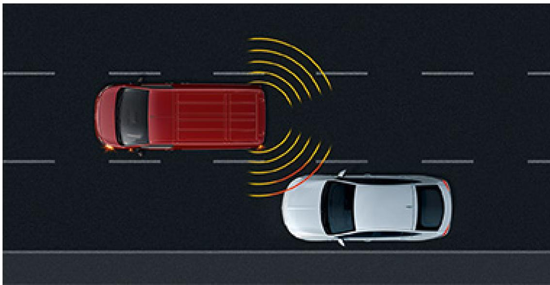
**Alerte angle mort :** utilise des capteurs et une projection visuelle dans le rétroviseur extérieur pour alerter le conducteur de la présence de véhicules dans les angles morts du Vivaro et éviter les accidents en cas de dépassement.
